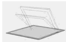
Betätigen Sie die Taste B und das Display fährt selbsttätig ein.
